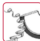
Заточка фрез по передней поверхности
