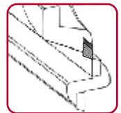
Заточка инструмента по задней поверхности
