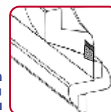
Заточка инструмента по задней поверхности
